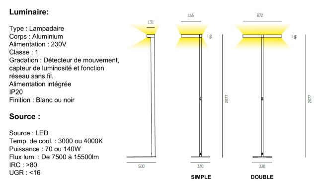
REMARQUES : Distribution lumineuse direct-indirect 30%-70%. Sélectionner modèle gauche ou droit en version simple.
