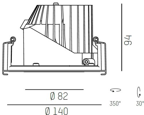
REMARQUES : Existe en version "HIGH EFFICIENCY", "DARK REFLECTOR" ou "LENS". Accessoires à commander séparément (verre de protection, grille basse luminance, verre dépoli ou lentille elliptique).
